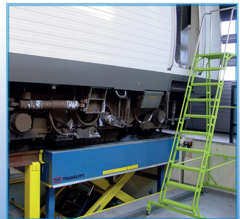
Kaikki pöydät on pintakäsitelty kulutuksenkestävällä maalilla, mutta tarvittaessa pöydät voidaan tehdä galvanoituna tai kuumasuojattuna ruostumattomasta teräksestä.
