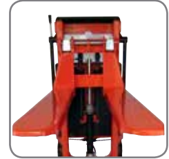
Säädettävät haarukat vakiona LF Minissä ja monissa ELF-vaunuissa.
